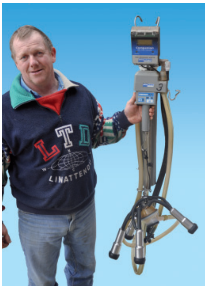
Die Melkzeuge sind mit einem Milchmengenmesser und automatischer Abnahme ausgestattet.
