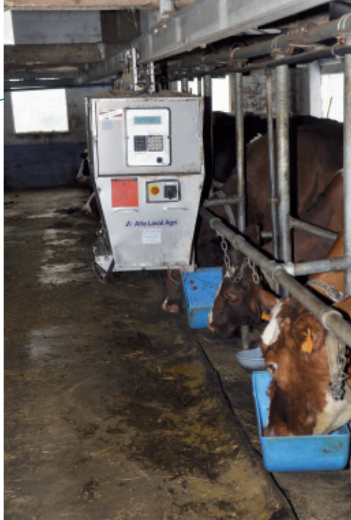
Das Kraftfutter wird mittels einem auf Schienen montierten Roboter vorgelegt.
